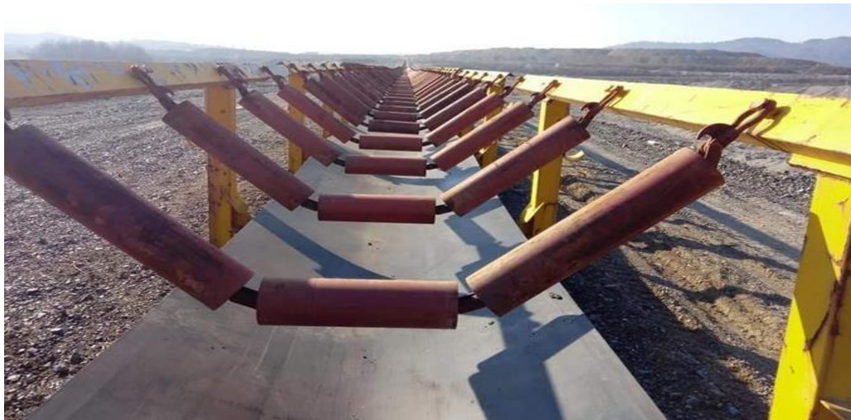
Slika 8. Sistem valjaka za vođenje trake
